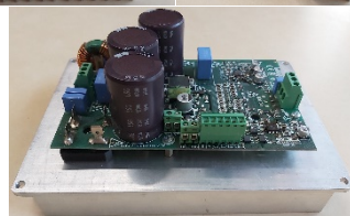
In figura inverter AOO 2M 008/015 0,75/1,5 Kw con filtro. Dissipatore 190x135x25 in aria libera senza ventola.
